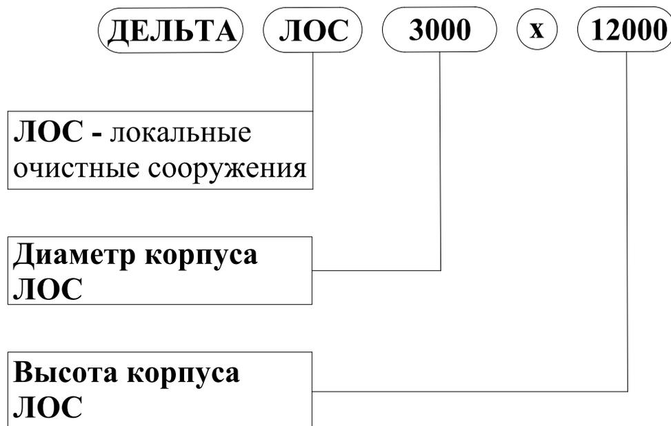
ПРИМЕР КОМПЛЕКТАЦИЯ ДЕЛЬТА ЛОС ПРОТОЧНОЙ СХЕМЫ:
