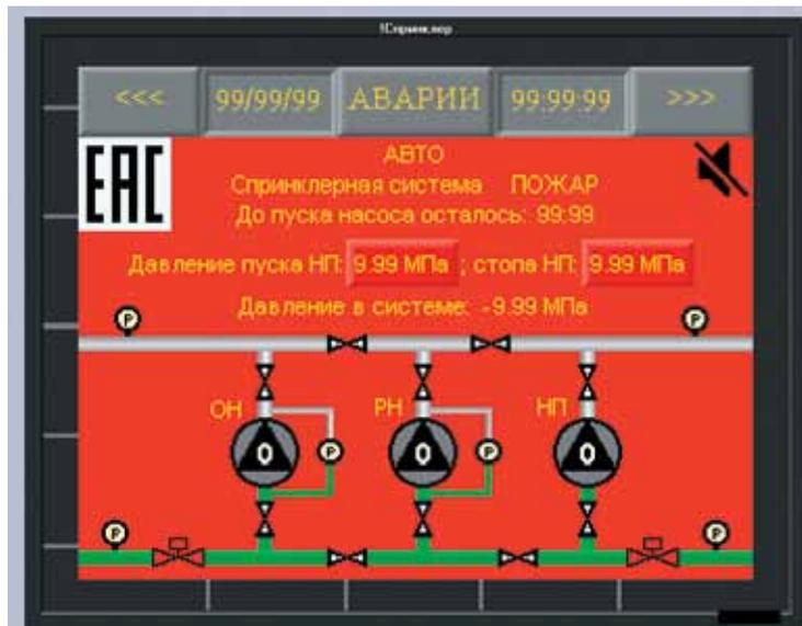
Рис. 4-2. Главный экран для спринклерной системы
